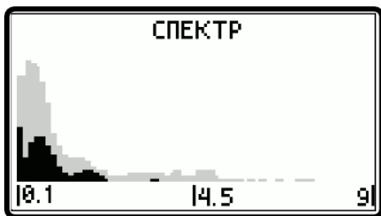
Рис. 6.5 Экран настройки спектра на бездефектном участке
