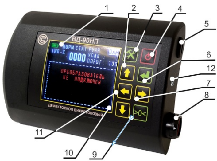
Рис. 3.2б Органы индикации и управления дефектоскопа вихретокового ВД-90НП ЛЕГАТ
