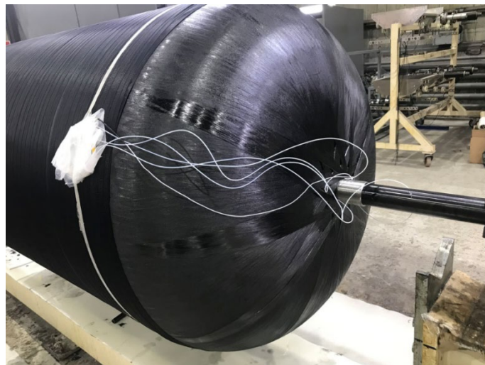
Рис. 4. Перенос выводов ВОД в пассивную зону
