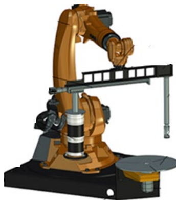
Рис. 2. Линейный детектор в жесткой связке с источником излучения
