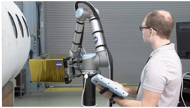
Роботизированный ТК фюзеляжа самолета в NASA (США)
