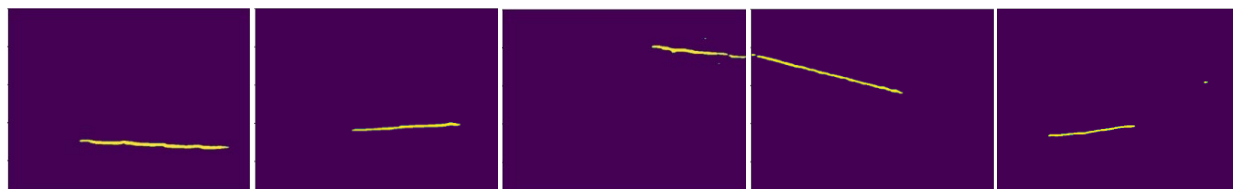
Рис. 2. Цифровые изображения образцов с трещинами (а), размеченные вручную карты трещин (б), результат определения усталостной трещины методом глубокого обучения (в)
