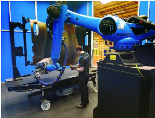
Роботизированный ТК углепластикового изделия сложной формы в фирме Safran (Франция)
