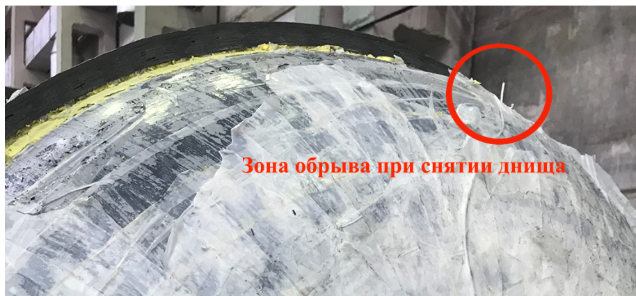
Рис. 8. Обрыв оптоволоконной линии при снятии технологической рубашки в зоне днища
