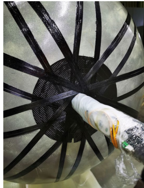
Рис. 3. Защита выводов ВОД салфетками в процессе намотки
