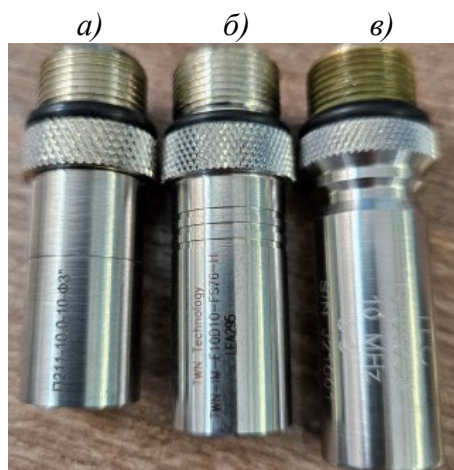
Рис. 2 – Преобразователи частотой 10 МГц: а) НЕРКОН; б) ТиВиЭн; в) TLC
