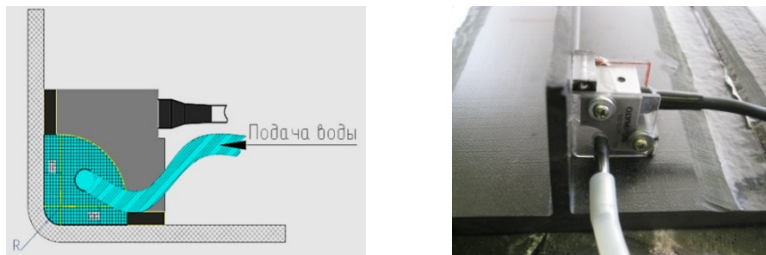
Рис. 5. Радиусная фазированная решетка с локальной иммерсионной ванной
