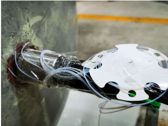
Рис. 2. Расположение выводов ВОД на фланце изделия
